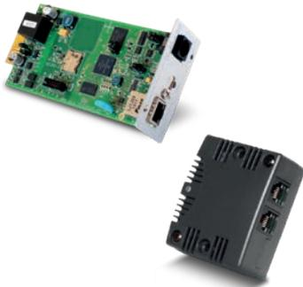
NetMan 204 consente l'integrazione e la gestione dell'UPS collegato direttamente su LAN 10/100 Mb utilizzando i principali protocolli (TCP/ IP, HTTP e SNMP, MODBUS/TCP o BACNET/ IP).
